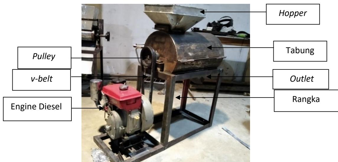
Gambar 9. Mesin Pencacah sampah organik tipe horizontal
