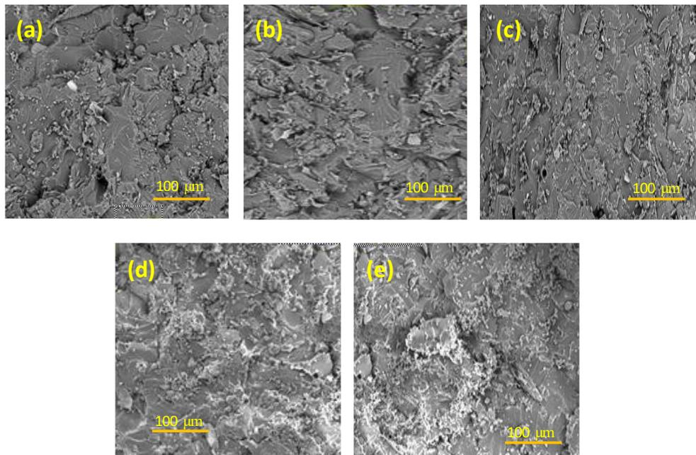
Figure 8. SEM photos of composites sample, (a) PEA, (b) PEB, (c) PEC, (d) PED dan PEE.
